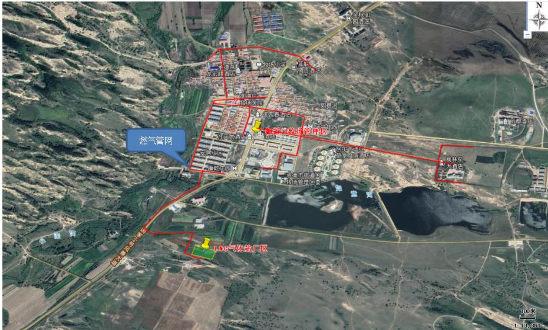
附图 4 LNG 气化站与燃气管网平面布置图
